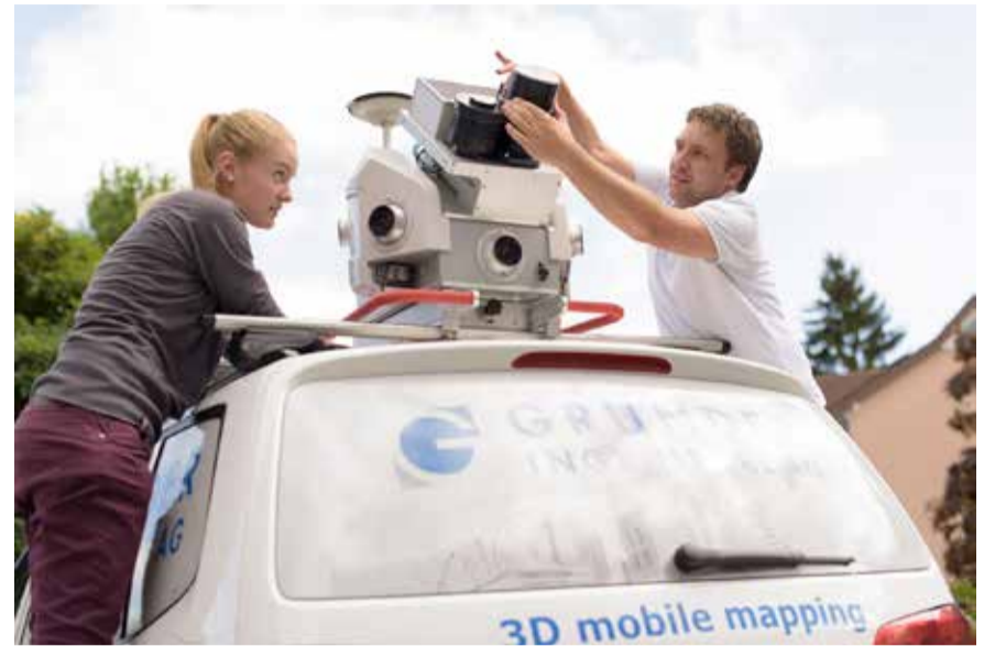
Das integrierte Photo- und Laserscanning-System Pegasus:Two auf PKW
